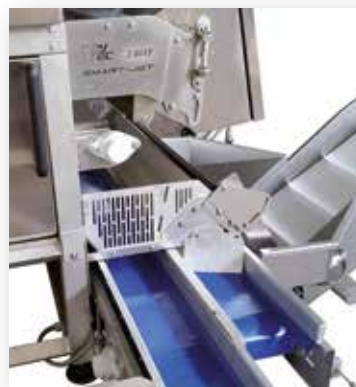
Système d'éjection 3 voies
